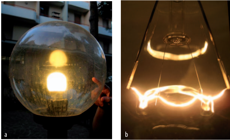
Abb. 9 Krönt ein Plasma diese Kugel- leuchte (a)? Die Nahaufnahme des Glüh- fadens einer transparenten Lampe (b) zeigt ein reelles Abbild des Fadens.
